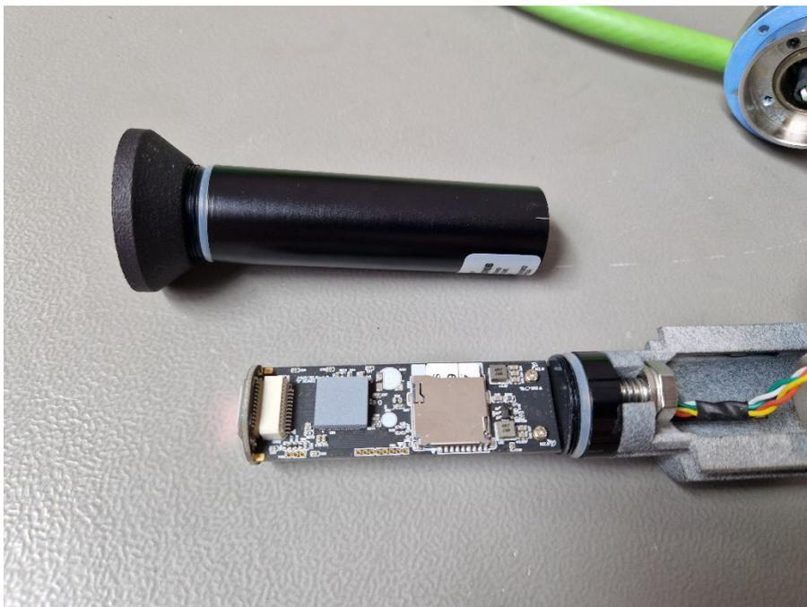
Bild 6-2 Position SD Karte im Kameramodul
